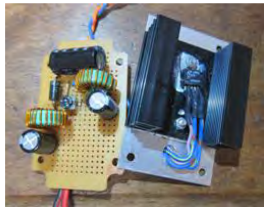
図 4. 12V → 16 ~ 19V 5A 昇圧電源
