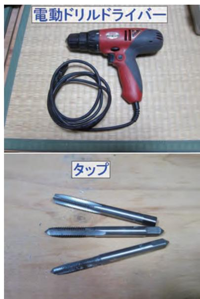
「2つめの神器」としては、金属にネジ穴加工を施す「タップ」です。先ほどのボール盤にてネジ穴を作るために
