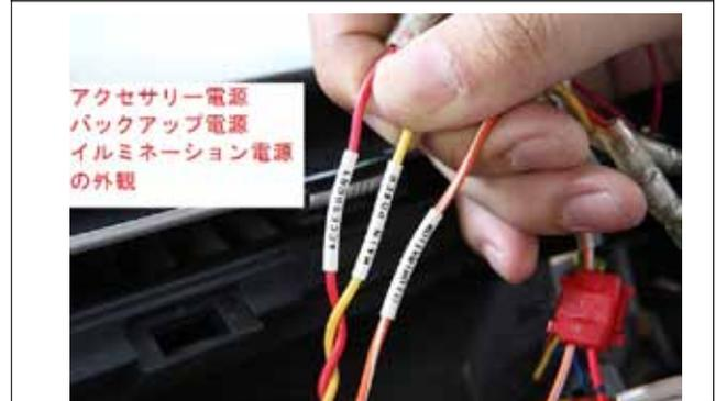
では具体的な設計に入っていきます。今回、リレーを使ってバッ直回路を組むのは、「アクセサリ電源／イルミネーション電源」の2つです。「バックアップ電源」は、常時電源 ON の電源ですから、リレーは不要で、直結配線で補強します。
