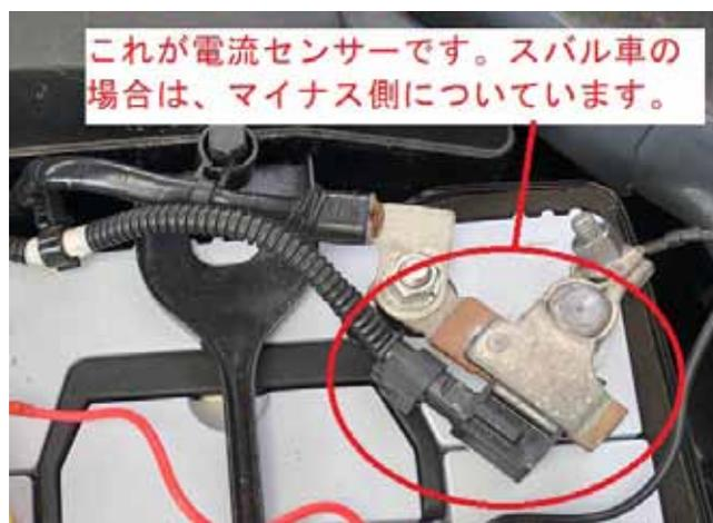
具体的には、次ページのように、電流センサーがバッテリーのプラス側端子についているのか、マイナス側端子についているのかを確認して、それぞれに適した箇所に、バッ直配線を接続していきます。これは要するに、「**バッ直配線により流れる電流が、必ず、電流センサーを通るように配線する。**」ということで、私の車の場合、マイナス側に電流センサーがついているので下記の図のように、マイナス側のバッ直配線は、車体アースポイントに接続することになります。
