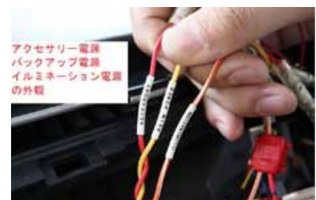
アクセサリ電源/イルミネーション電源/バックアップ電源の3本の電源ケーブルが見つ
