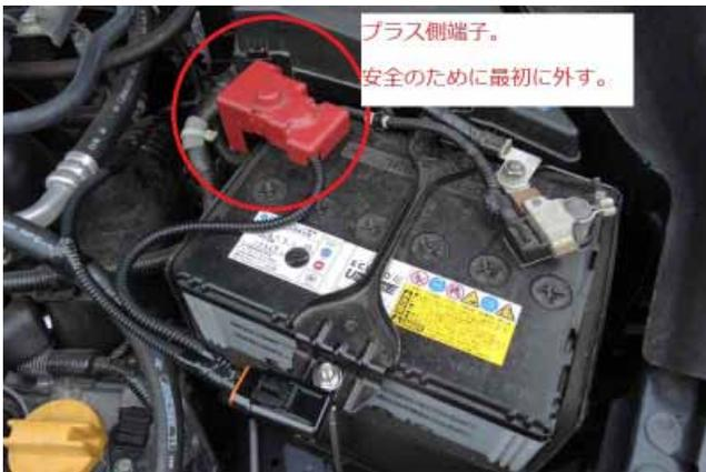
では最初に作業するのは、エンジンルーム内の配線です。先ほど製作した、バッテリーの+端子とつながる部分の配線を、エンジンルーム内に這わせて、そこから車内に引き込みます。
