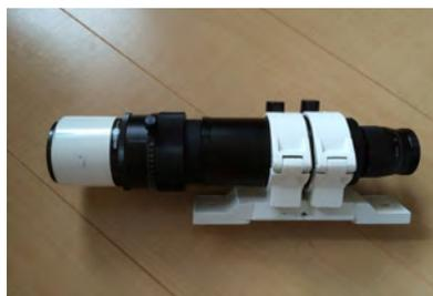
・口径:60mm、焦点距離:350mm、明るさ:F 5.8
