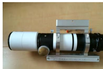
・光学方式:2枚玉ED・アポクロマート屈折望遠鏡 (共通)
